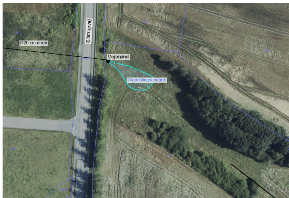
Overrislingsområde fra Ø20 cm -drænet i området ved Silstrupvej.
